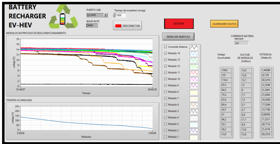
Figura 25. Descarga de la batería durante cuatro horas a un amperio. Fuente: Autores.
