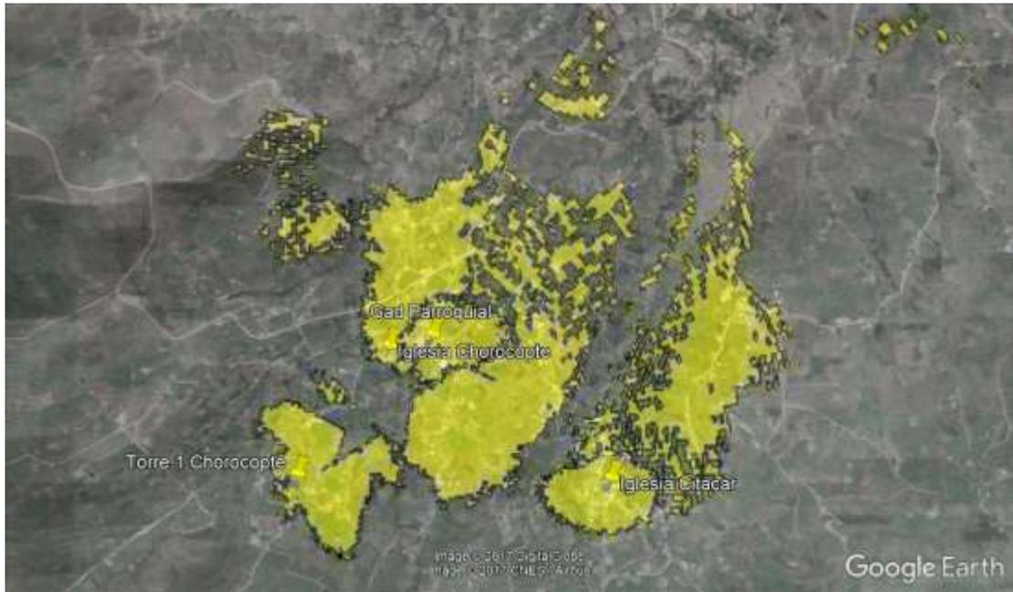
Figura 2. 12 *Área de Cobertura con dos Antenas Omnidireccionales y una Sectorial, en la Parroquia de Chorocopte*
