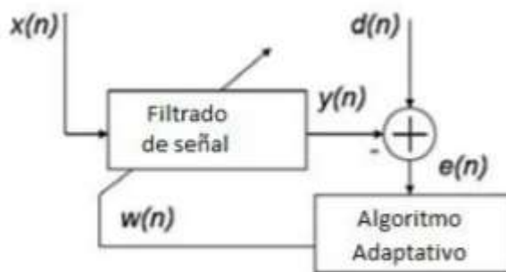
Figura 3.6 Topología general de filtros adaptativos
