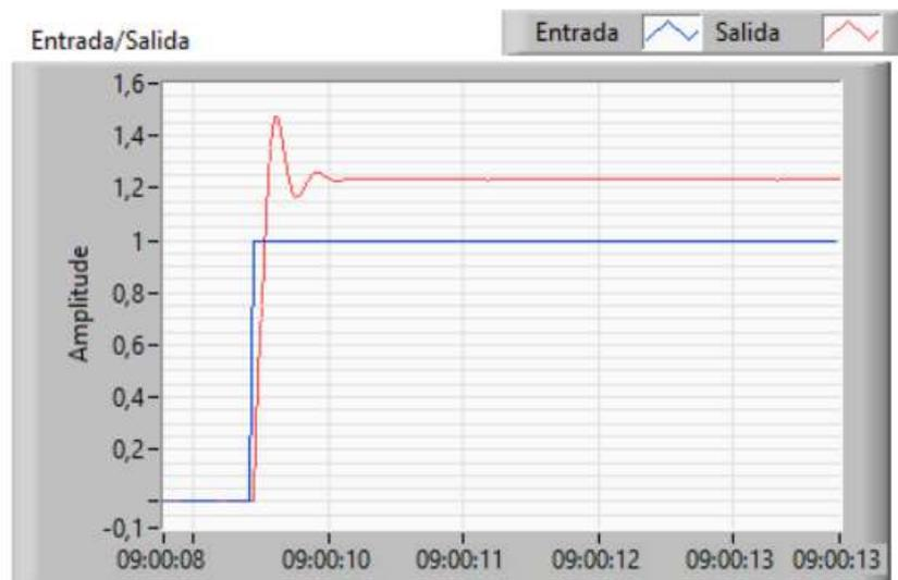
Figura 2. 23 Respuesta del sistema de segundo orden dado una entrada de referencia en LabVIEW.
