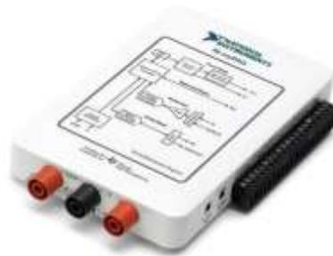
Figura 2. 15 *Dispositivo de adquisición de datos myDAQ de National Instruments.*
