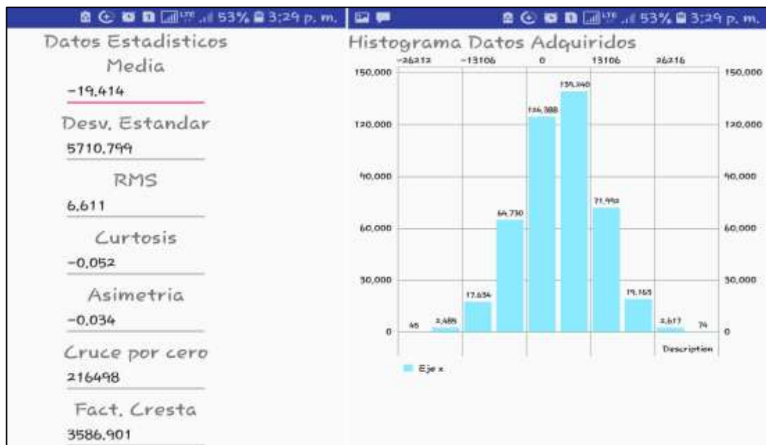
Figura 41 Resultados obtenidos de la primera muestra de audio capturada a velocidad alta en el banco de vibraciones.
