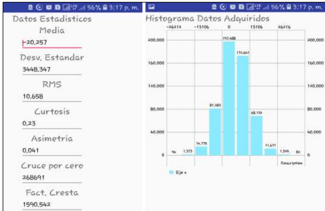
Figura 40 Resultados obtenidos de la última muestra de audio capturada a velocidad media en el banco de vibraciones.
