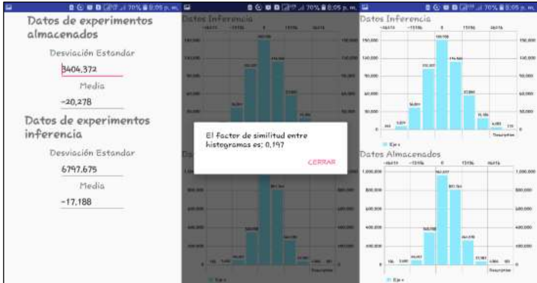
Figura 45 Resultados de inferencia del banco de vibraciones a velocidad media con fallo.
