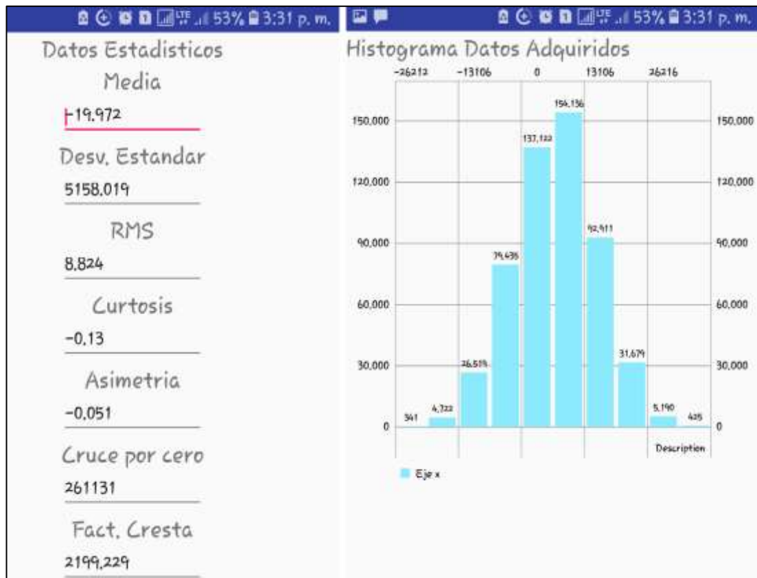
Figura 42 Resultados obtenidos de la última muestra de audio capturada a velocidad alta en el banco de vibraciones. Fuente: Autor
