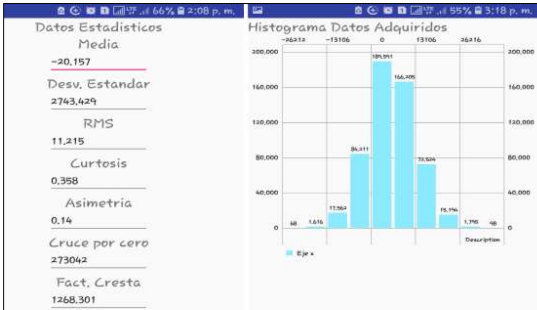
Figura 38 Resultados obtenidos de la última muestra de audio capturada a velocidad baja en el banco de vibraciones.
