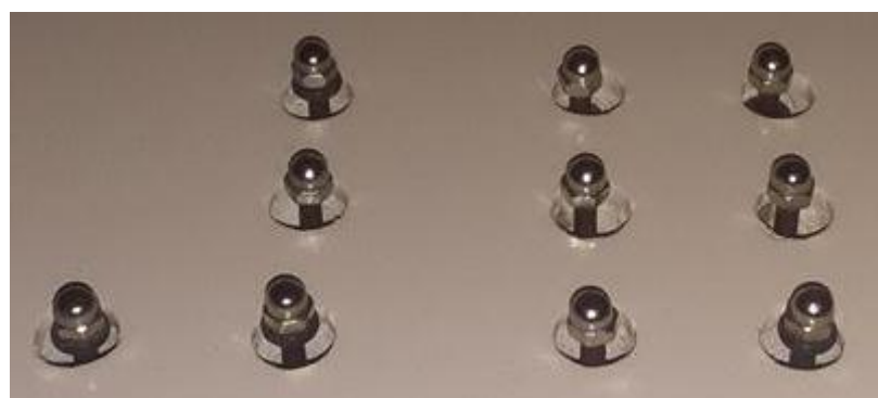
Figura 4.16 Solenoides usadas para el modo lectura
