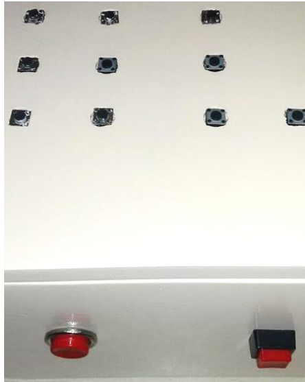
Figura 4.20 Pulsadores usados para el modo escritura
