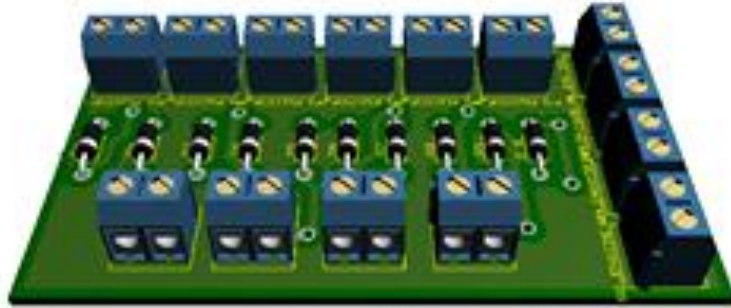
Figura 3.17 Diodos de Protección
