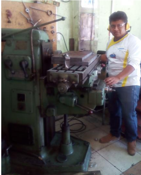
1. Maquinado de placas en fresadora
