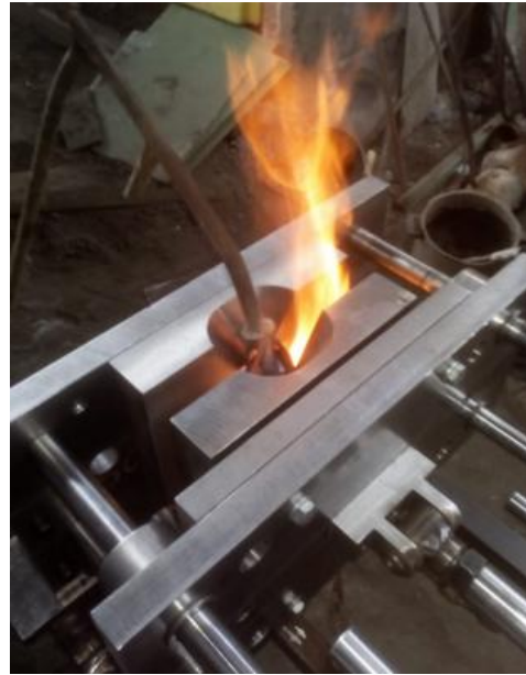
6. Pre calentamiento del molde
