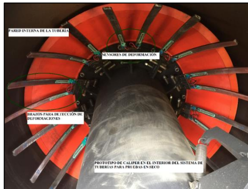
Figura 5. 7 Pruebas de la detección de deformaciones
