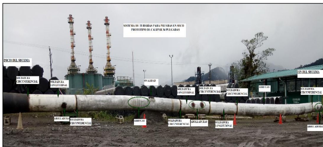
Figura 5. 1 Sistema de tubería de pruebas en seco
