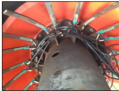
Figura 3. 2 Adaptación del sensor Flex en el prototipo.
