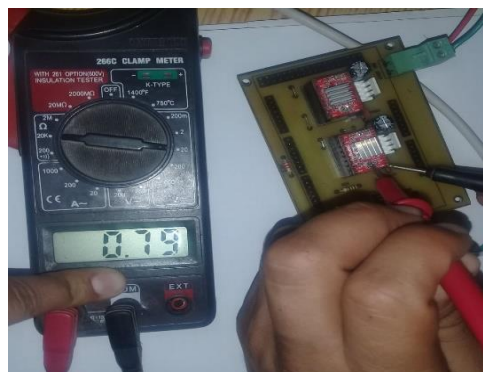
Figura 3.5 Calibración del driver A4988
