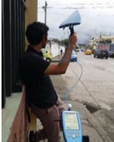
Figura 4.7. Medición campos electromagnéticos Punto 1 Universidad Laica.
