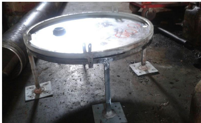
Figura 35: Base fija junto con parte inferior del soporte de antena banda C.
