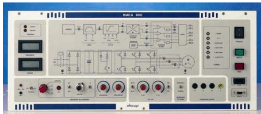
Figura 2.6 Inversor trifásico Alecop RMCA-900
