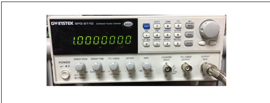
**Figura 13.** Generador de Funciones de la Marca GwInstek con Número de Serie SFG-2110.
