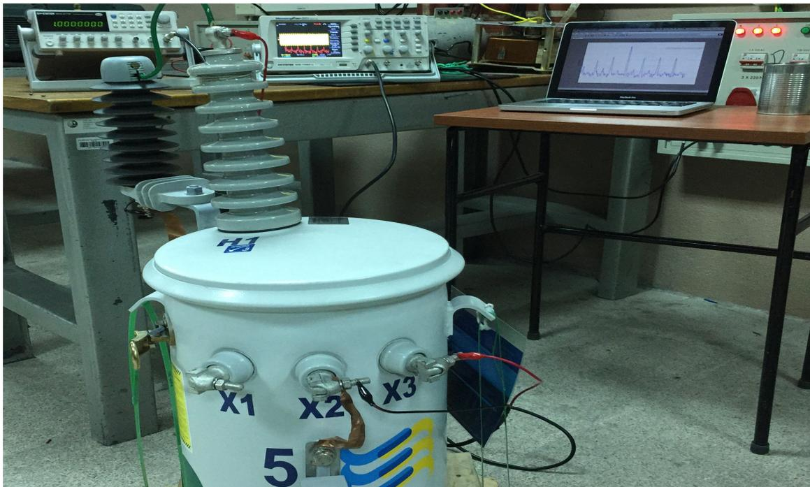
**Figura 17.** Foto Real de un Analizador de Respuesta en Frecuencia para un Transformador de Distribución con sus Equipos Utilizados.
