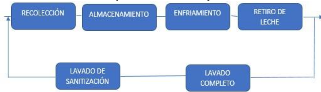
Figura 2.3 Procesos en el tanque
