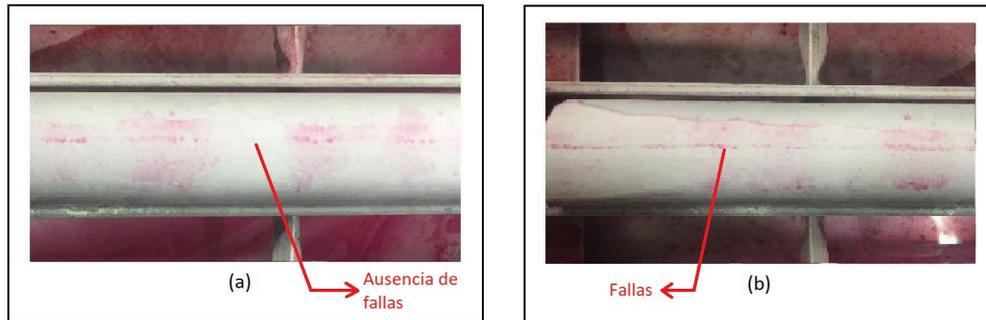
**Figura 1.18** – Resultados de tintes penetrantes: a) Probeta del ensayo #3, b) Probeta del ensayo #8. **Fuente:** Autores.
