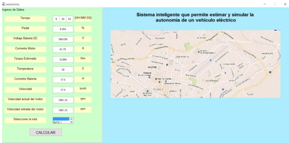
Figura 3.3 Pantalla principal del programa que permita estimar y simular la autonomía de un V.E.
