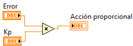
Figura 65. Diagrama de bloque Labview (Acción Proporcional)
