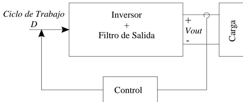
**Figura 2.30.:** Esquema general de control [15]
