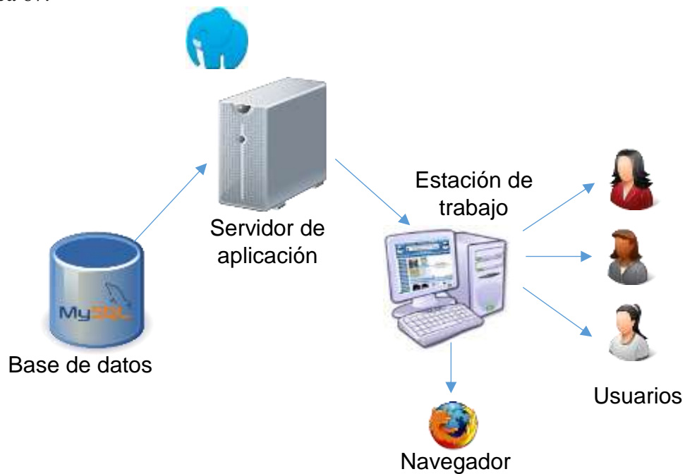
Gráfico 67: Diagrama de esquema de funcionamiento Elaborado por: Autoras
