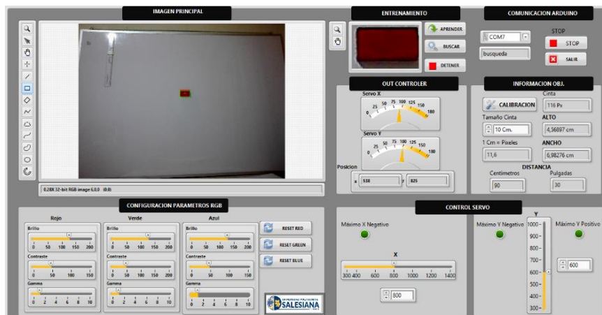
Figura 68. Posición de Servos vista central de sistema DEO
