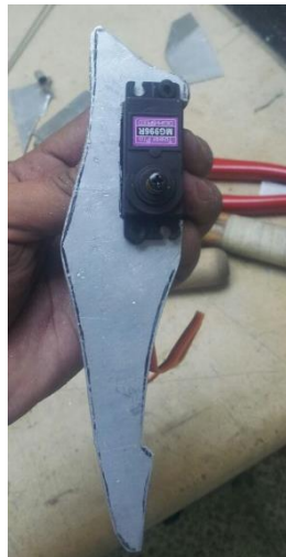
Figura 59. Corte y Ensamblaje de Piezas del Robot (2)
