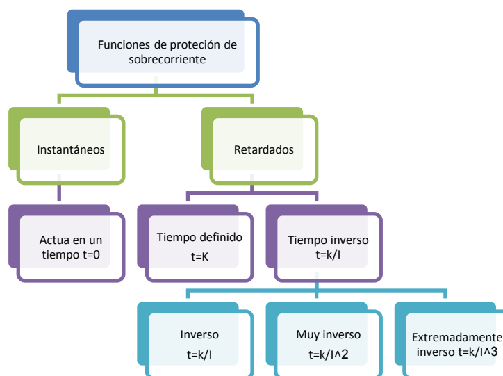
FIGURA 11. PROTECCIÓN SOBRECORRIENTE SEGÚN EL TIEMPO DE OPERACIÓN. FUENTE: LOS AUTORES.
