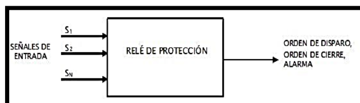
FIGURA 8: ESQUEMA LÓGICO DE UN RELÉ DE PROTECCIÓN. FUENTE: [1].
