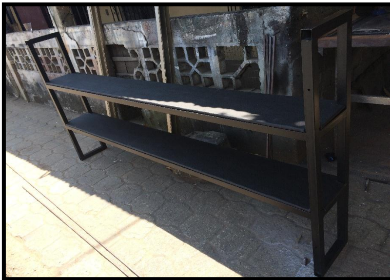
FIGURA 21: CONSTRUCCIÓN DE ESTRUCTURA METÁLICA (LÁMINA FRONTAL- CALADO). FUENTE: LOS AUTORES.
