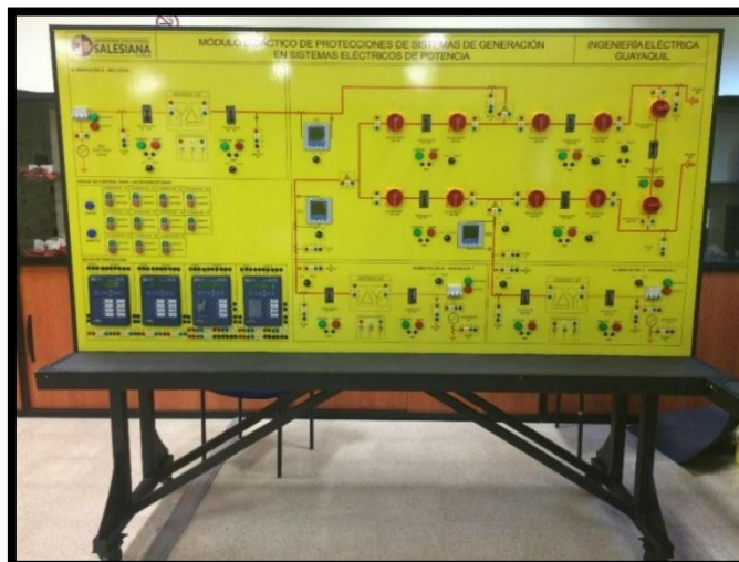
FIGURA 28: INSTALACIÓN DE ELEMENTOS SOBRE TABLERO. FUENTE: LOS AUTORES.
