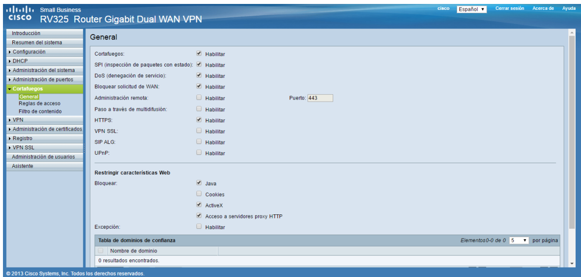
Ilustración 35 Configuración de Firewall
