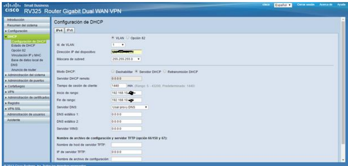
Ilustración 31 Configuración de la LAN DHCP
