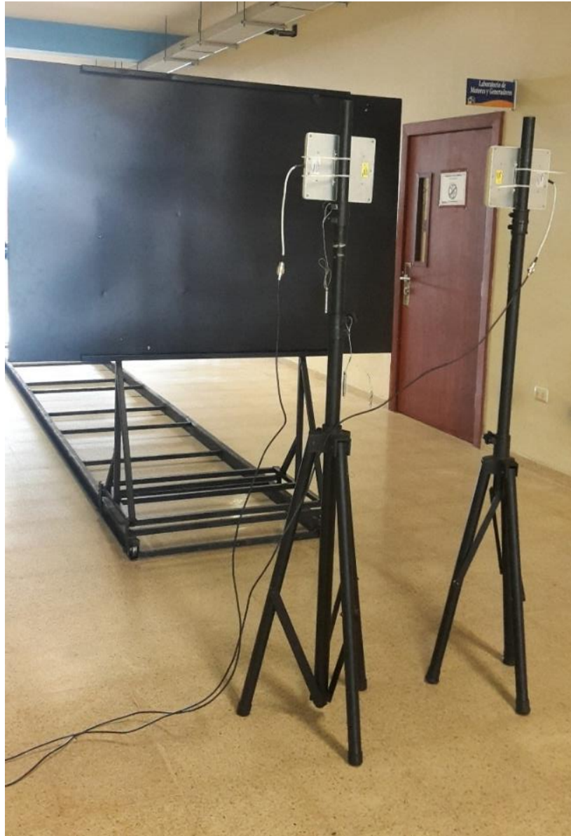
Figura 35. Tercer escenario, pruebas realizadas con USRP dentro del laboratorio y antenas en el pasillo
