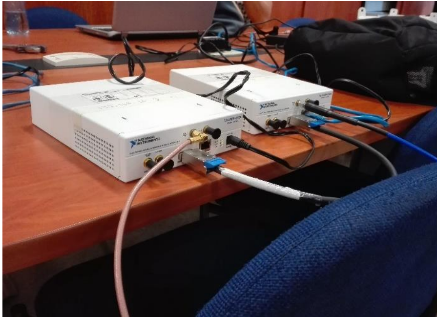
Figura 59. Conexiones de NI - USRP 2920, cable MIMO, cable ETHERNET y cable coaxial
