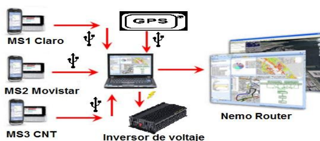
Figura 1.1. Esquema de conexión de los equipos.
