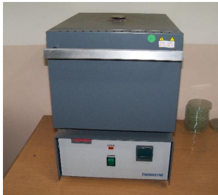
Figura 4. Estufa (Horno eléctrico) utilizado para el tratamiento térmico en la muestras de suelo. Elaborado por: Fernando Carrera.
