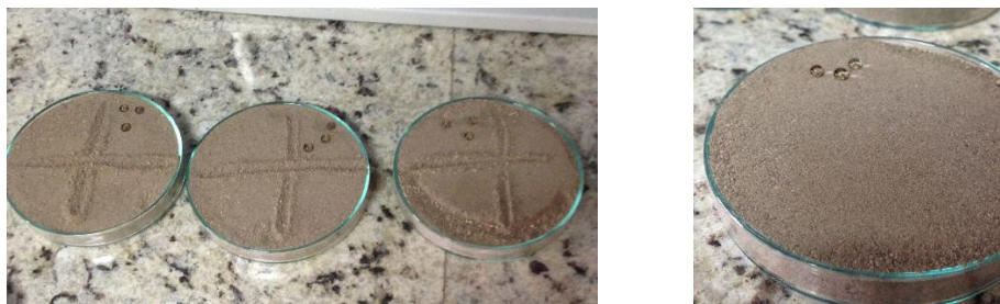
Figura 10. Determinación de la repelencia al agua de las muestras de suelo aplicando los métodos WDTP Y TPE. Elaborado por: Fernando Carrera.
