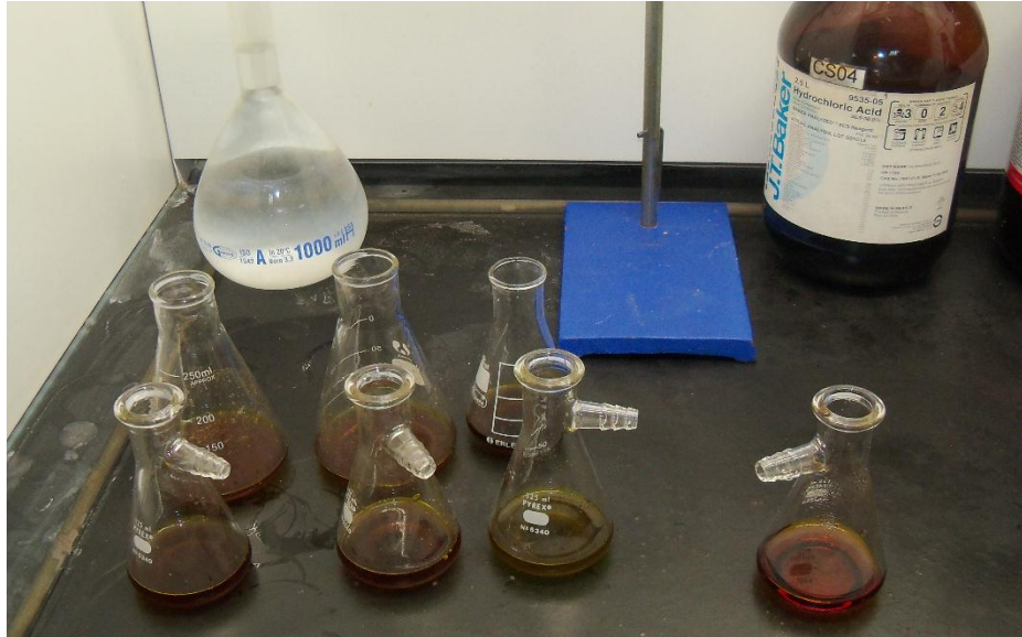
Figura 5. Proceso de oxidación y digestión (reposo de 30 minutos) de las muestras de suelo con dicromato de potasio y ácido sulfúrico. Elaborado por: Fernando Carrera.
