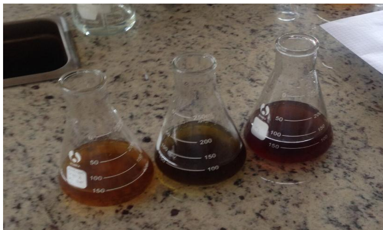
Figura 6. Titulación de las muestras con sulfato amónico férrico e identificación de viraje de color. Elaborado por: Fernando Carrera.
