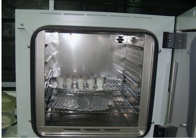
Figura 9. Determinación de humedad en las muestras antes y después del tratamiento térmico. Elaborado por: Fernando Carrera.
