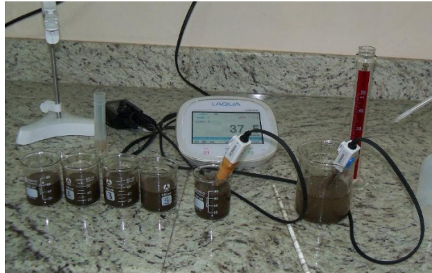
Figura 7. Determinación de pH y conductividad de las muestras antes y después del tratamiento térmico. Elaborado por: Fernando Carrera.
