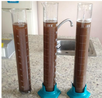
Figura 8. Determinación de la textura en las muestras de suelo antes y después del tratamiento térmico. Elaborado por: Fernando Carrera.
