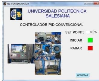
Figura 8. Interfaz gráfica del controlador PID convencional
