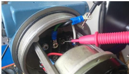
Figura 3.2. Conexión de las puntas del multímetro y los terminales del sensor
