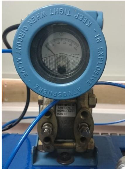
Figura 3.1. Sensor de caudal Rosemount 1151 analógico
