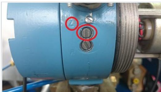
Figura 3.3. Calibración a cero del sensor de Caudal Rosemount 1151
