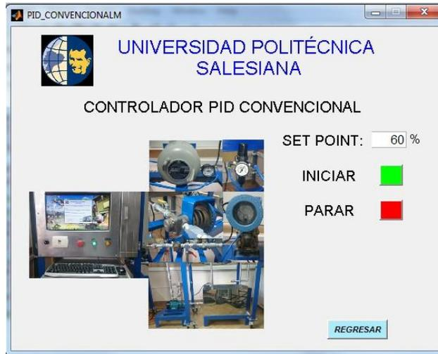
Figura 3.22. Interfaz gráfica del controlador PID convencional
