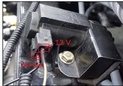
Figura 74. Conexión de señal de entrada y alimentación en el solenoide de la válvula EGR.
