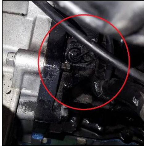
Figura 15. Ubicación del sensor CKP en el banco didáctico CRDi Diésel. Fuente: Autores
