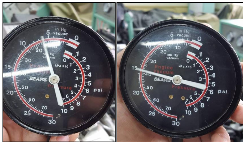
Figura 76. Variación de vacío por acción del solenoide de la válvula EGR controlado por un Sistema Difuso. Fuente: Autores.
