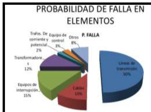
FIGURA 32 PROBABILIDAD DE FALLA EN ELEMENTOS DEL SEP [13].
