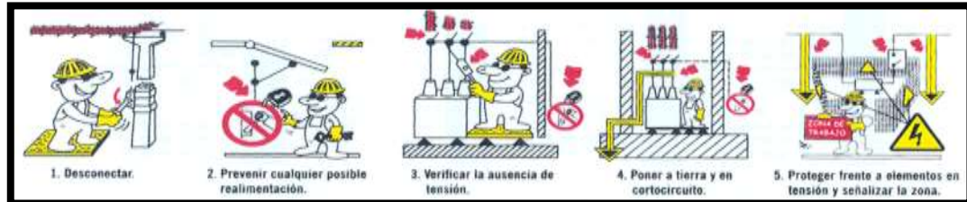
FIGURA 132 REGLAS DE ORO PARA EL TRABAJO ELÉCTRICO, FUENTE: ALBERTO MARTÍNEZ.
