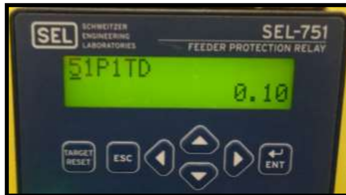
FIGURA 88 CONFIGURACIÓN DE TIEMPO PROTECCIÓN 51 DE FASE, FUENTE: LOS AUTORES.
