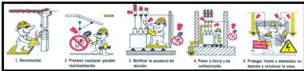
FIGURA 125 REGLAS DE ORO PARA EL TRABAJO ELÉCTRICO, FUENTE: ALBERTO MARTÍNEZ.
