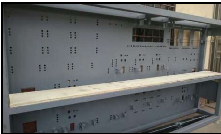
FIGURA 62 ESTRUCTURA PREPARADA CON ANTI CORROSIVO, FUENTE: LOS AUTORES.
