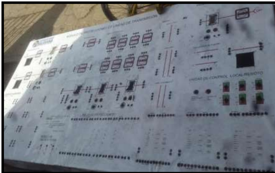
FIGURA 60 INICIO DEL CALADO DE LAS PERFORACIONES EN EL TABLERO, FUENTE: LOS AUTORES.
