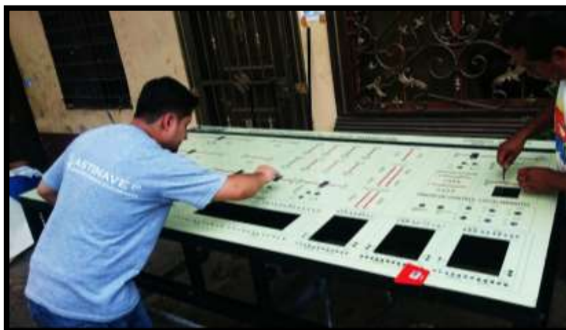
FIGURA 66 CENTRADO Y PEGADO DE VINIL EN EL TABLERO, FUENTE: LOS AUTORES.
