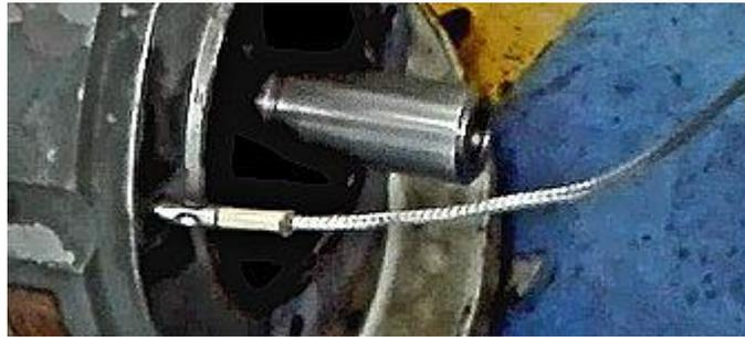
Figura 23. Termopar tipo K acoplado al motor
