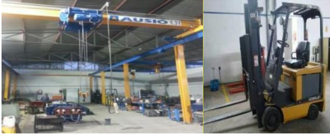
Figura 1. Puente grúa y montacargas que facilitan el movimiento de partes y piezas de los motores
