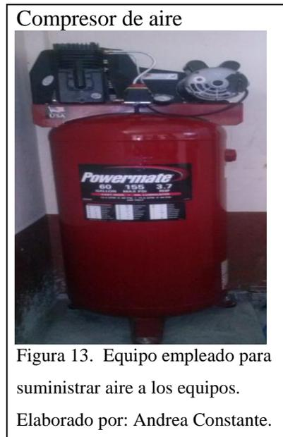
Equipo con presión nominal de 6,2 bares y presión máxima de trabajo de 10,0 bares, con un caudal de aire libre suministrado a presión nominal de 250 l/min., también constan de un motor de 2 HP que trabaja con una tensión de 220V trifásico y una velocidad de 3450 r.p.m con una frecuencia de 60 Hz, cuya transmisión es por banda.
