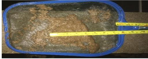
Figura 39. Formación de los flóculos dentro del límite de 22 minutos y con pH dentro del rango.
