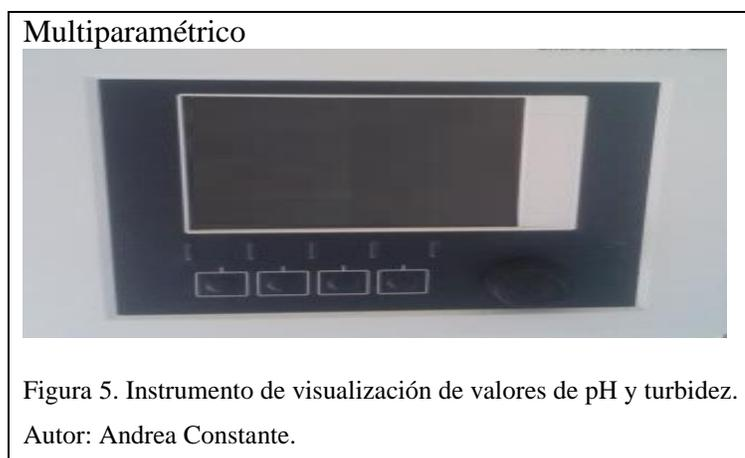
Su principal beneficio es la configuración y rápida implementación en campo. Consta de una pantalla digital y botones de navegación, los mismos que permiten desplegar los valores y las unidades de las variables utilizadas en el proceso los cuales son: turbidez y pH/redox.
