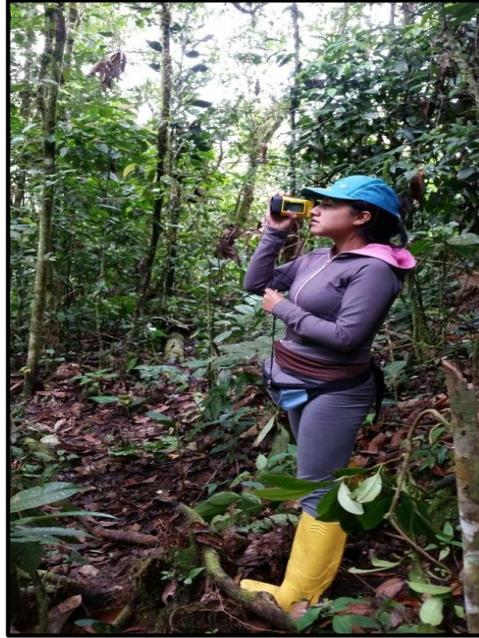
Figura 3. Uso del Hipsómetro Nikon para medir la altura total del fuste de cada individuo.
