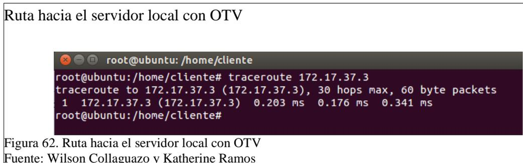
La ruta trazada hacia el servidor local está compuesta desde el cliente que realiza la solicitud desde la dirección 172.17.37.4 al servidor con dirección 172.17.37.3, esta solicitud es procesada únicamente por el Gateway del sitio al igual que al utilizar el enrutamiento dinámico y túneles VPN.
