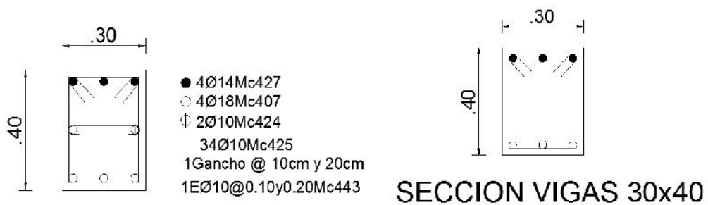
Figura 23. Sección y armadura principal de vigas
