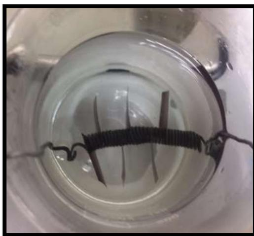
Figura 17: Detectores sumergidos en solución de hidróxido de Sodio
