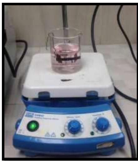
*Figura 19: Detectores sumergidos en agua destilada y en agitación magnética.*
