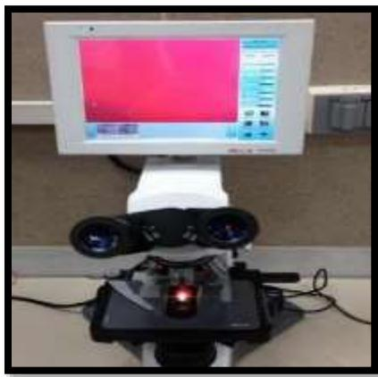
*Figura 21: Microscopio empleado para el conteo de trazas nucleares*
