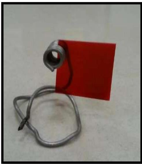
*Figura 20: Etapa final de revelado, secado de detectores LR-115.*
