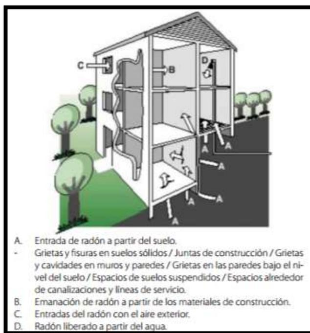
Figura 6: Esquema de fuentes típicas de radón y rutas de entrada, fuente: NTP 440: Radón en ambientes interiores.
