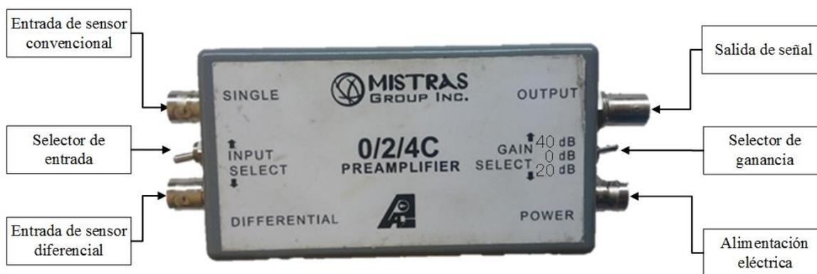
Figura 3. Preamplificador 0/2/4C [5]
