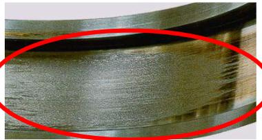
Figura 7. Rodamiento con desgaste abrasivo en pista interna [13]
