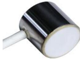
Figura 71. Sensor acústico WD S/N FV52 [88]
