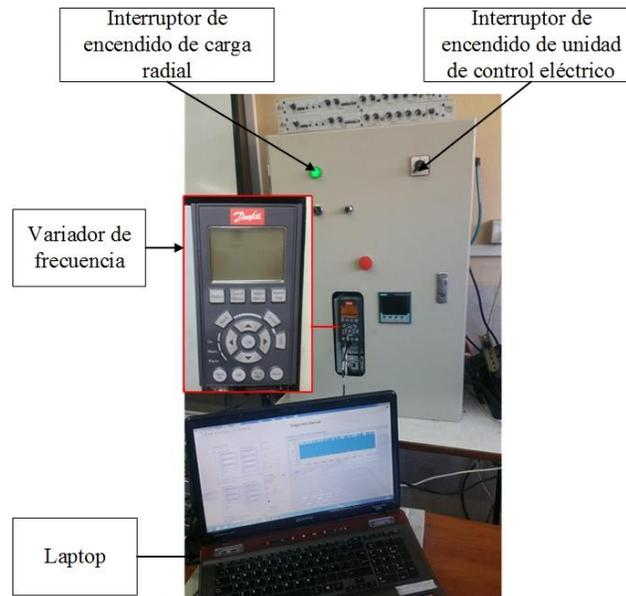
Figura 22. Unidad de control eléctrico del banco de pruebas.
