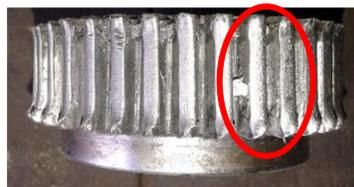
Figura 16. Engranaje con fallo por *wear*[25]
