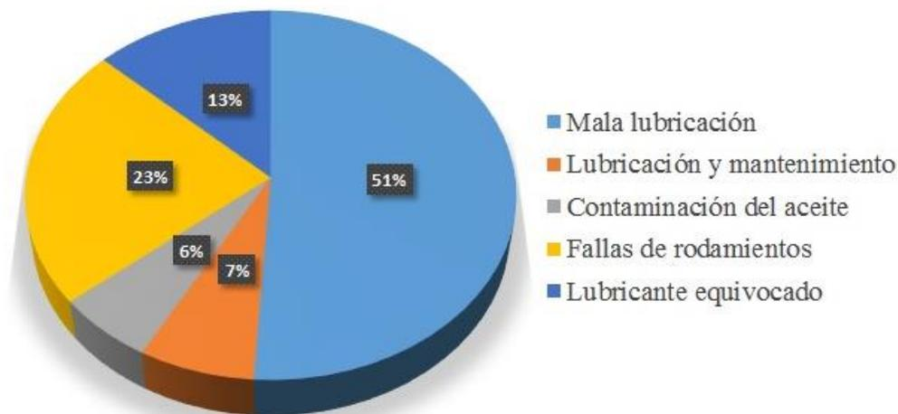
Figura 2. Fallos en cajas de engranajes, conforme estudio de BHP Billiton [3]
