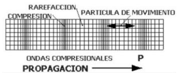
Figura 40. Propagación de onda P de emisión acústica
