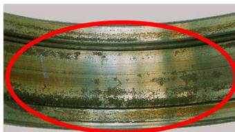
Figura 8. Rodamiento con corrosión en pista interna [13]
