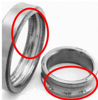
Figura 12. Fallo por fatiga en pista interna y externa de rodamiento [13]
