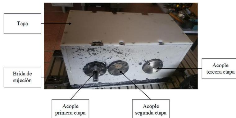
Figura 2. Principales elementos de Caja Reductora
