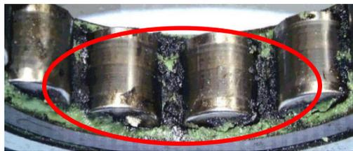
Figura 10. Elementos rodantes con fallo por erosión eléctrica [18]
