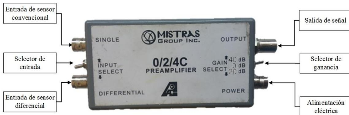
Figura 73. Preamplificador 0/2/4C [89]
