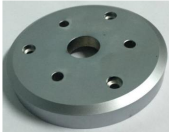
Figura 4.6 Tapa del motor terminada. Fuente: Autores.
