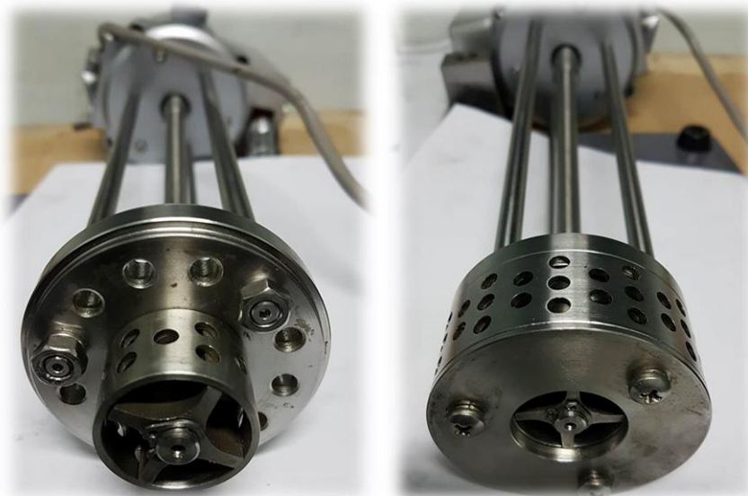
Figura 4.18 Ensamblaje del rotor, estator, arandela y cabezal de trabajo. Fuente: Autores.
