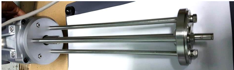
Figura 4.17 Ensamblaje de las columnas en el motor. Fuente: Autores.
