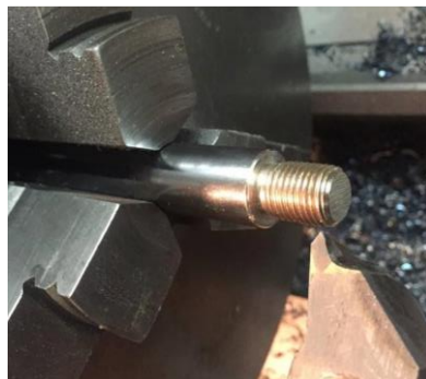
Figura 4.3 Roscado del eje soporte. Fuente: Autores.
