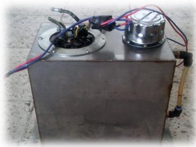
Figura 28. Tanque de combustible portátil
