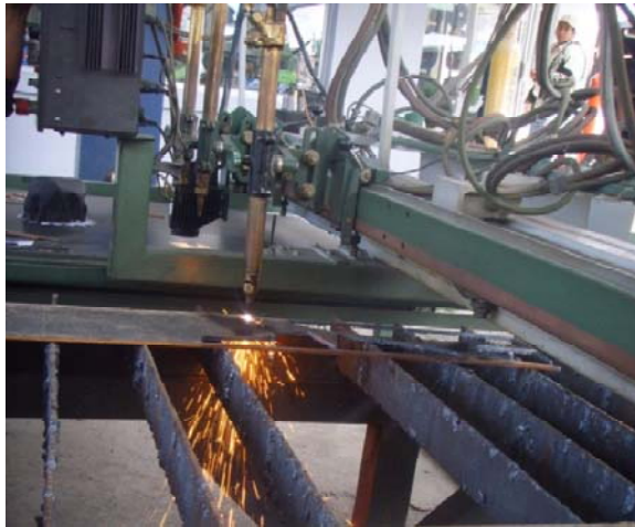
Fig. 4.25. Corte de los moldes de las bases “Oxicorte”
