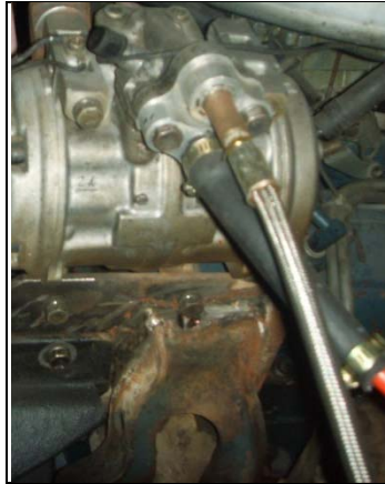
Fig. 4.47 Conexión neumática al compresor
