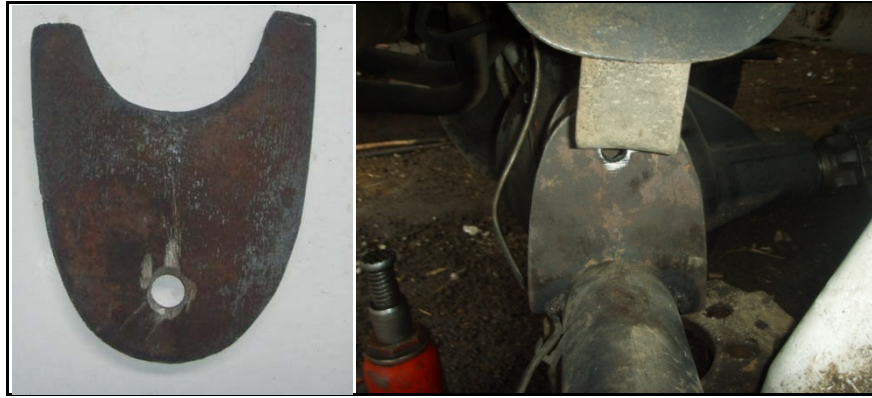
Fig. 4.27. Acople de bases para la sujeción de las bolsas neumáticas (Fuente: Autores)
