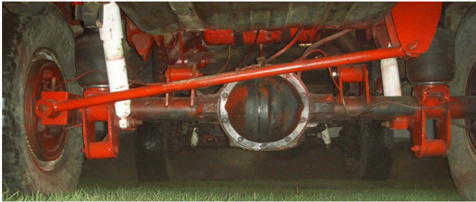
Fig. 4.30 vista de la barra estabilizadora colocada transversalmente.
