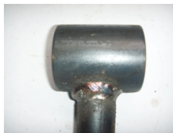
Fig. 4.26. Soldadura de templon
