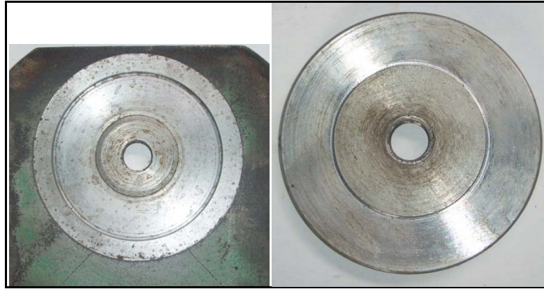
Fig. 4.32 La base inferior se asienta sobre el eje su forma geométrica es únicamente en forma de círculo debidamente torneada
