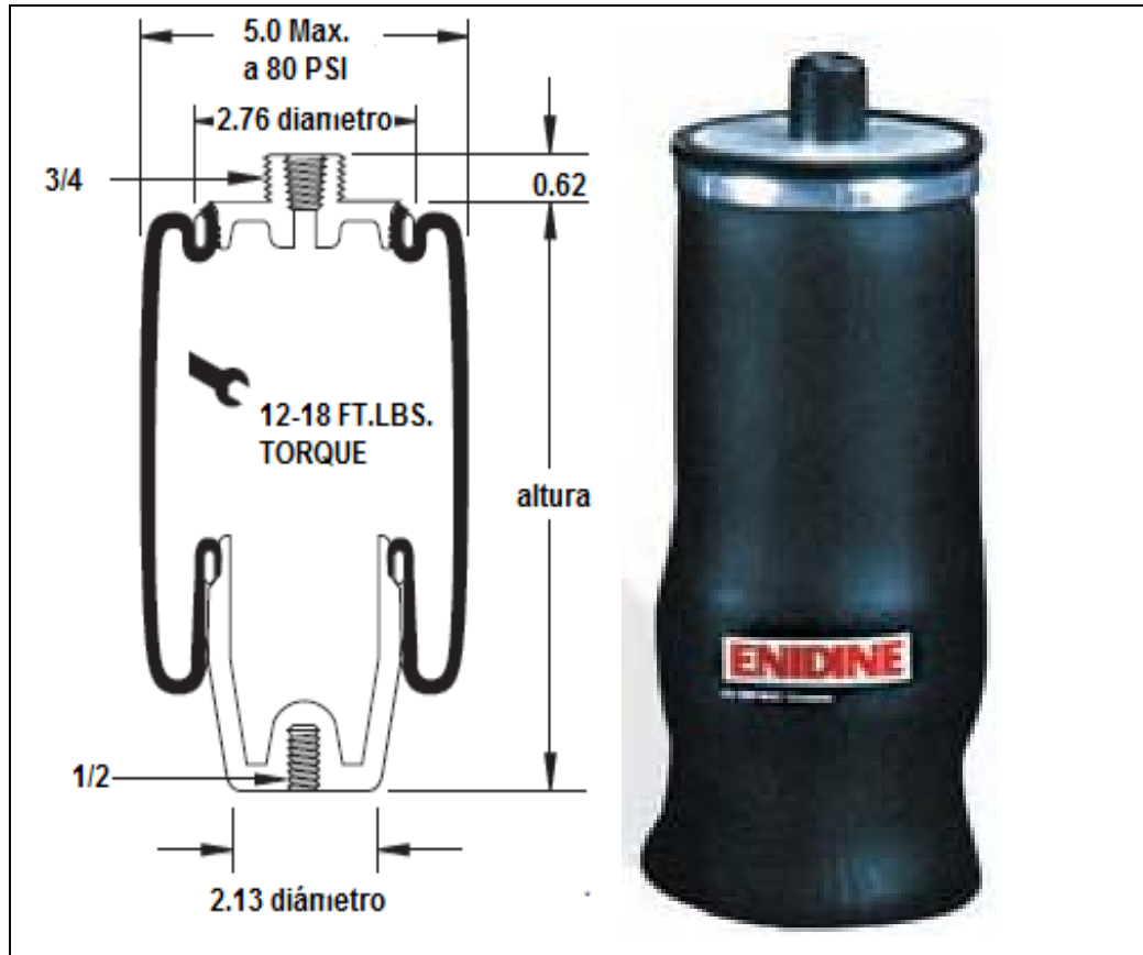
Figura 3.19. Muelle neumático de camisa reversible
