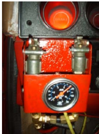
Fig. 4.37. Vista del manómetro y válvulas de inflado en cabina
