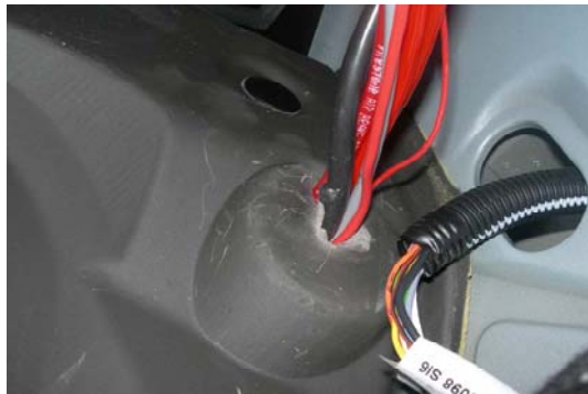
Fig. 4.40. Paso de los tubos neumáticos y los cables eléctricos de marcha del compresor desde la cabina al compartimento motor
