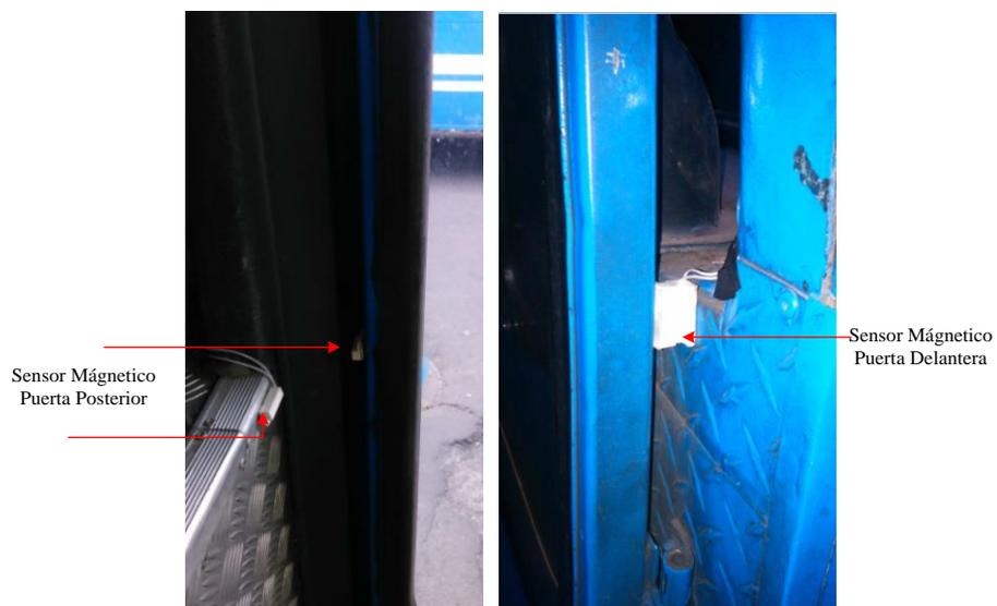
Figura 24. Cada puerta tiene un sensor magnético, que indica su estado (abierto o cerrado)
