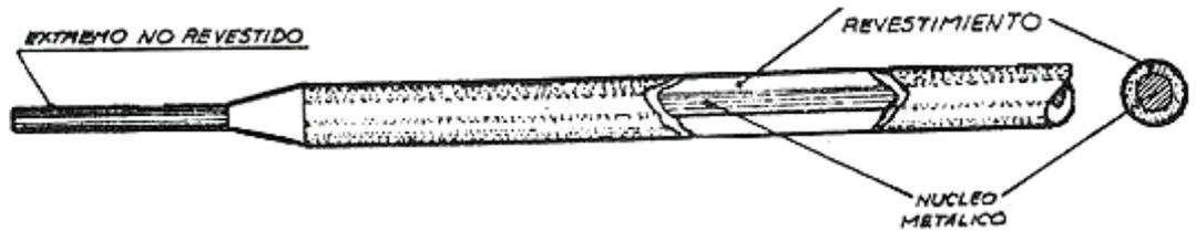
Figura2.28 Electrodo revestido
