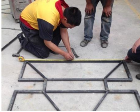
Figura 191 Comprobación base de la estructura del vehículo eléctrico.
