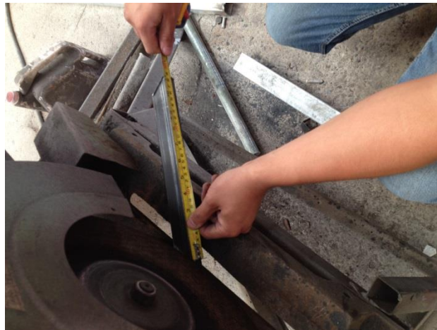
Figura 182 Comprobación de la medida exacta del tubo y su ángulo
