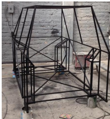
Figura 208 Pintado de la estructura.
