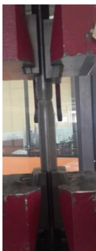
Figura 55 Fractura de la probeta
