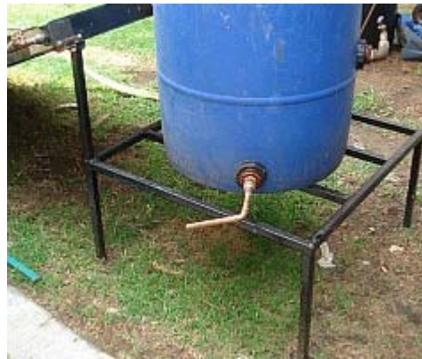
Fig. 21 Construcción del tanque y su soporte
