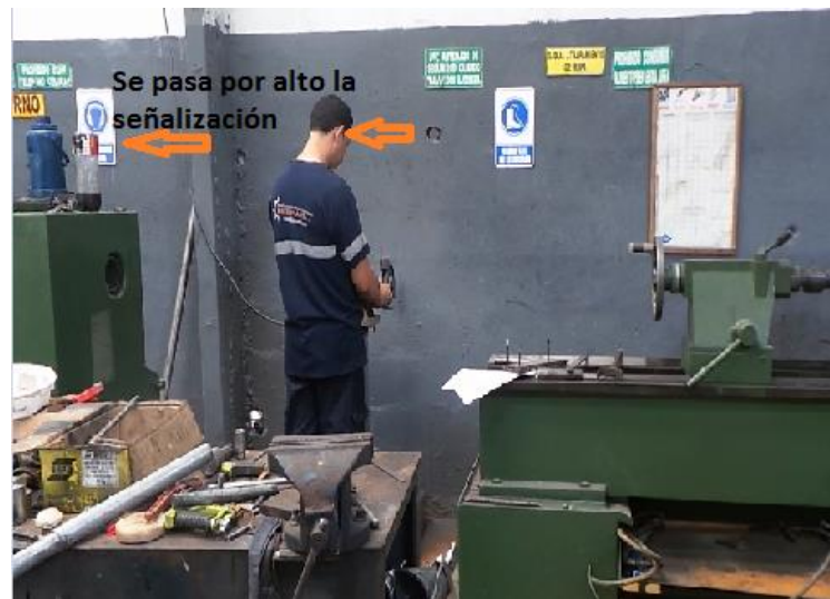
Figura 19 Señalización Obligatoria sin ejecución
