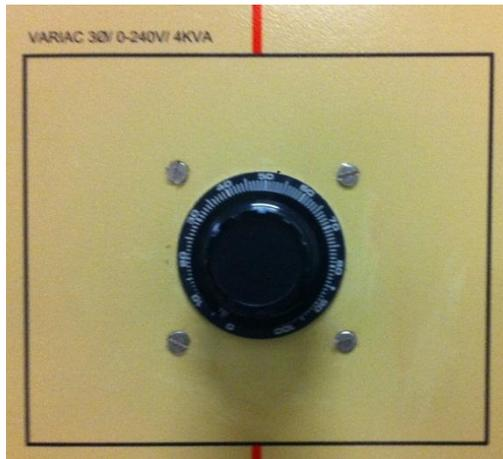
Figura No. III- 5 Variador de voltaje
