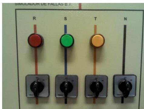
Figura No. III- 6 Simulador de fallas en el lado primario
