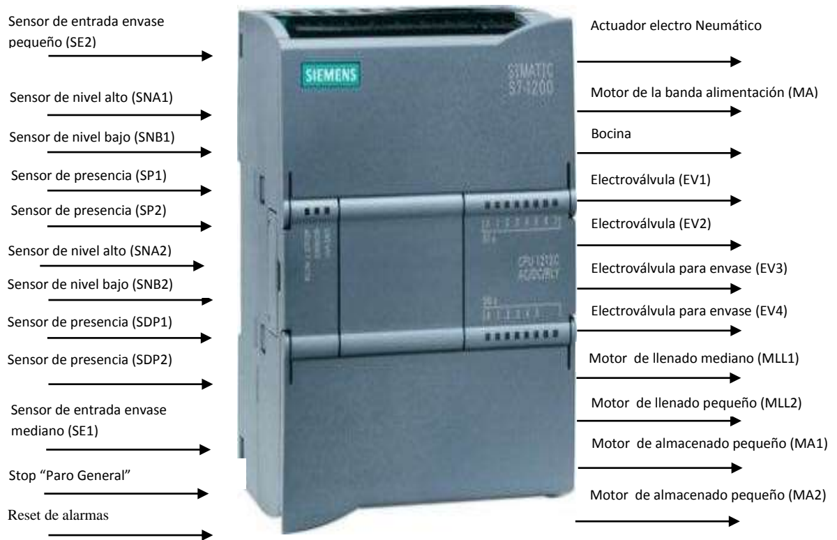
Figura 4. Programador Lógico Programable s7-1200. Por: SIEMENS (2015). PLC SIEMENS .Recuperado de: https://otomotroaccess.wordpress.com/
