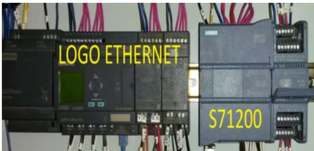
Figura 36. Equipo S7-1200 y Logo Ethernet. Por: SIEMENS (2015). Fotografía del Logo y PLC's S7-1200.
