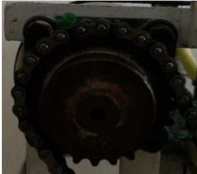
Figura 19. Piñón acoplado en la chumacera de pared. Por: El Autor.
