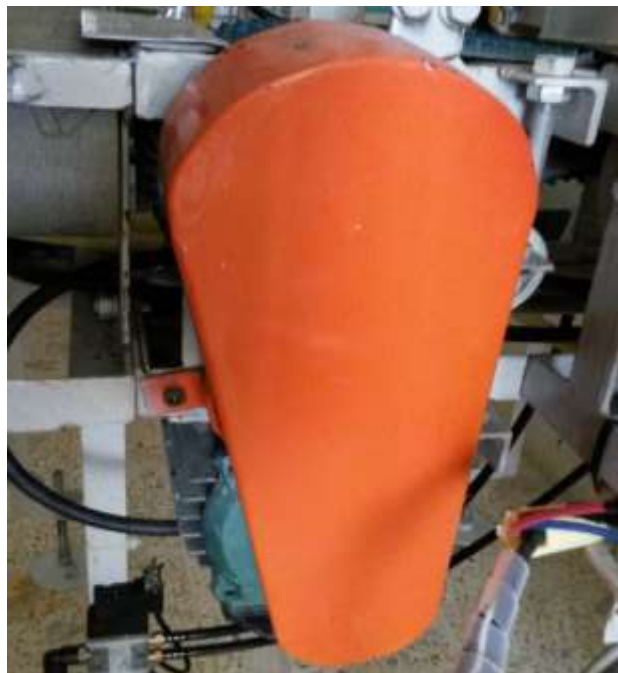
Figura 22. Instalación de la guarda de seguridad.
