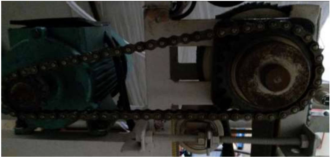
Figura 21. Montaje de la cadena de transmisión entre el sistema de transportador y el motor asíncrono.
