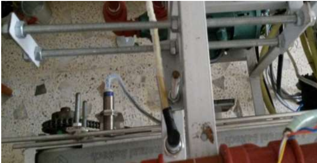
Figura 27. Sistema de calibración del sensor analógico. Por: El Autor.
