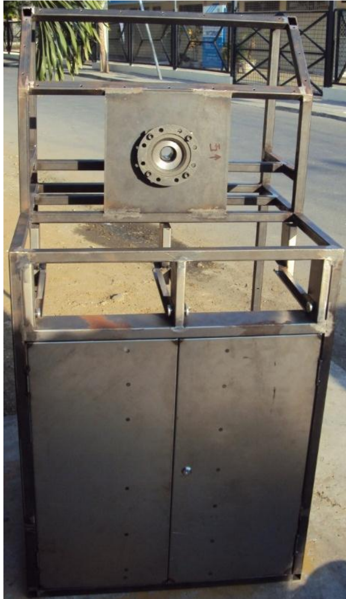
Figura 3.3 Vista isométrica de la estructura del banco.
