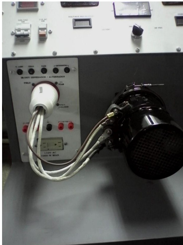
Figura 4.2 Generador del Helicóptero Bell 206B.
