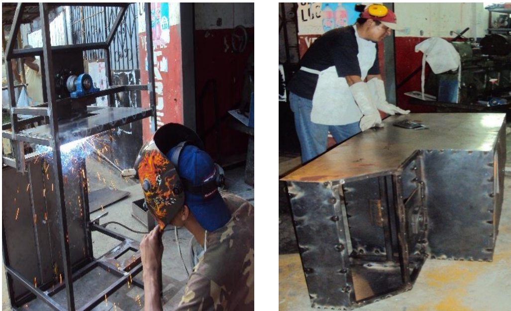
Figura 3.5 Laminado de la estructura
