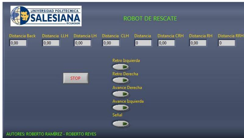
**Figura 4.85** Panel Frontal del VI “Captura fpga” en LabVIEW FPGA. Aquí se observa los controles para el movimiento del robot y los indicadores de distancia de los sensores de ultrasonido.
