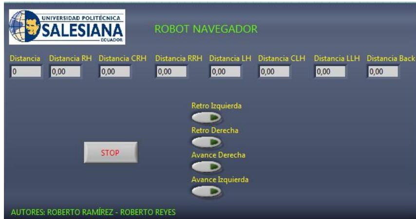
**Figura 4.75** Panel Frontal del VI LabVIEW FPGA “Esquivador fpga”. La figura muestra a través de indicadores la distancia tomada de cada uno de los sensores de ultrasonido, además del control manual del robot móvil.
