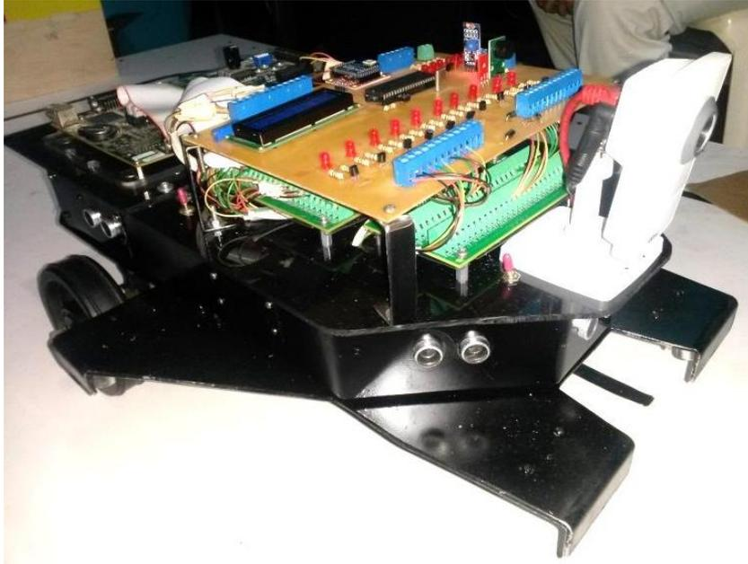
**Figura 3.13** Parte lateral del robot móvil. Robot Móvil ya ensamblado con todos los dispositivos y tarjetas conectados y listo para funcionar.
