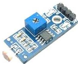
**Figura 4.14** Sensor de luz con fotorresistencia. Vista superior de la fotorresistencia montado en una tarjeta que permite obtener salida analógica y salida digital. ELECTRONICA.COM.VE. (2015). Modulo Sensor de Luz por Fotorresistencia CDS. Obtenido de [http://electronica.com.ve/new/catalog/product\\_info.php?products\\_id=35](http://electronica.com.ve/new/catalog/product_info.php?products_id=35)
