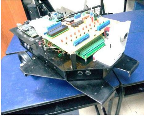
**Figura 4.61** Robot Móvil trabajando como Anti-caídas. La imagen muestra como el robot evita caerse al momento de desplazarse dentro de una mesa o una base similar.
