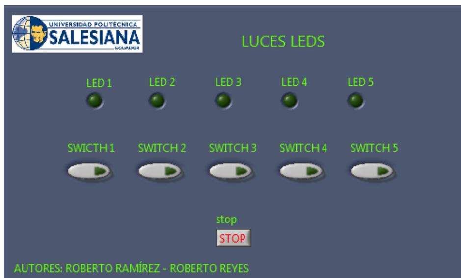
**Figura 4.9** VI Panel Frontal Control de luces LED. VI que permite controlar el encendido y apagado de los Leds en la parte superior.
