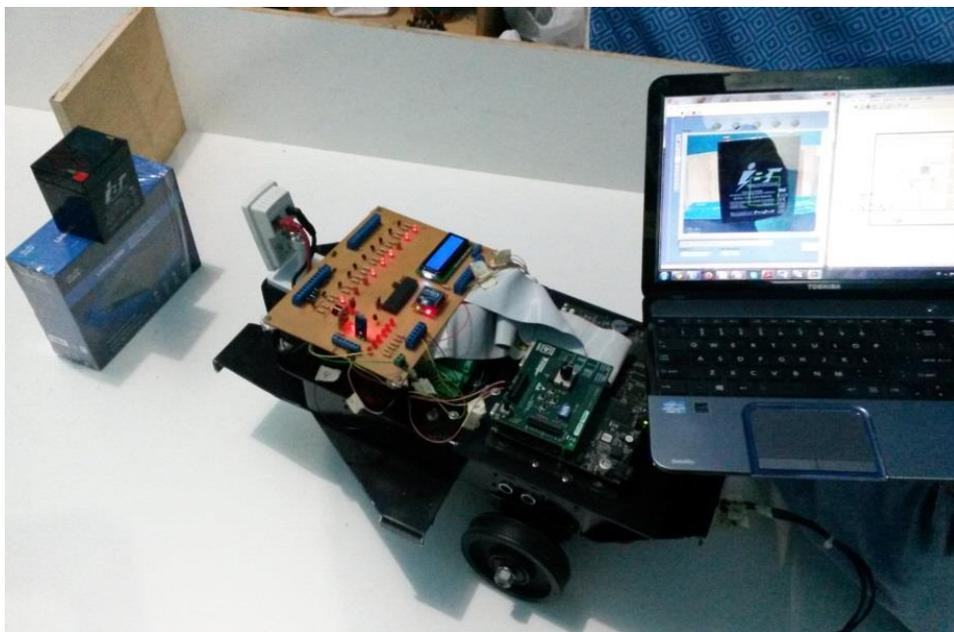
**Figura 4.92** Visualización de la imagen a través de la Cámara AXIS. En la figura se observa como la imagen es transmitida desde la cámara hasta el Panel Frontal de LabVIEW PC.
