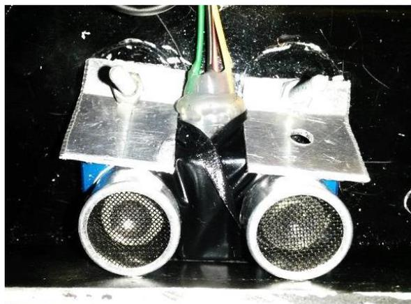
**Figura 4.60** Imagen del sensor de ultrasonido ubicado en el robot móvil. Este es uno de los cinco sensores de ultrasonido que tiene el robot móvil, todo ubicados en la parte inferior.
