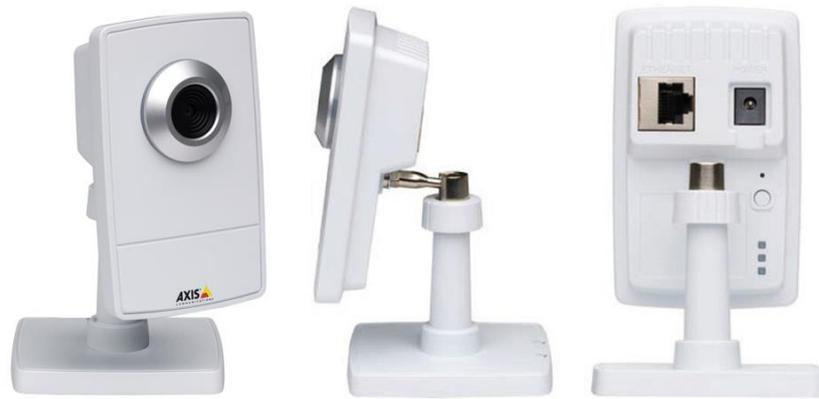
**Figura 4.79** Cámara de red AXIS M1011. La imagen nos proporciona diferentes ángulos de la cámara, donde podemos observar desde su base hasta conexión de red y alimentación. SINSEC. (2015). Cámaras de red. Obtenido de <http://www.edasistemas.com/servicios.php>
