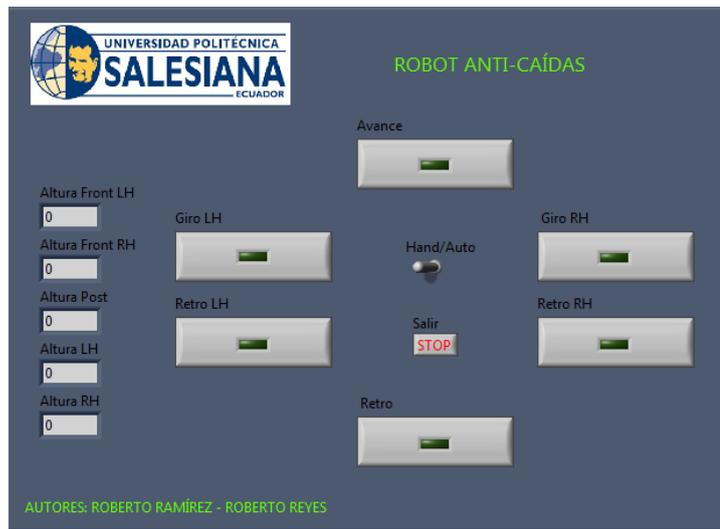
**Figura 4.57** Panel Fronal del VI “Anticaídas RT”. Panel Frontal desarrollado para mostrar la altura de cada sensor de ultrasonido además de poder controlar el robot de forma manual o automática.
