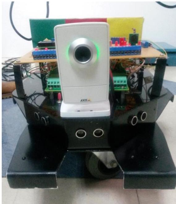
**Figura 3.14** Parte lateral del robot móvil. Robot Móvil ya ensamblado con todos los dispositivos y tarjetas conectados y listo para funcionar.
