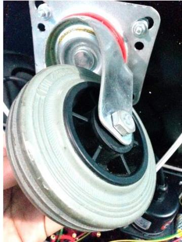
**Figura 3.5** Rueda LOCA del robot móvil. Rueda que se acopla al direccionamiento que toman los motores DC.
