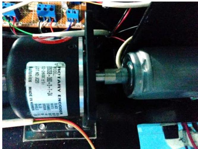
**Figura 3.6** Acople del Encoder con el motor DC. Figura del motor conectado al encoder a través de acople de silicon para evitar roces en el eje del motor.
