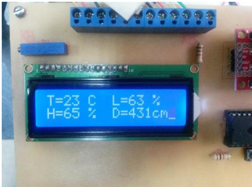
**Figura 4.30** Visualización de datos en el LCD. Captura de imagen tomada del robot móvil enviando datos de medición desde los sensores.
