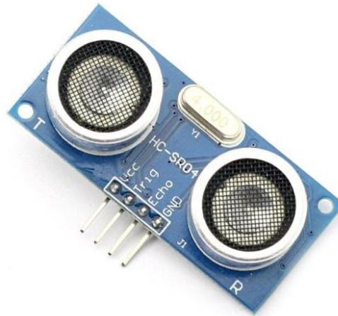
**Figura 4.15** Sensor de Ultrasonido HC-SR04. Vista frontal del sensor con 4 pines que son VCC, Trigger, Echo, GND, para conexión directa a la placa electrónica. DIGIBAY. (2013). HC-SR04 Ultrasonic Proximity sensor. Obtenido de <http://www.digibay.in/hc-sr04-ultrasonic-proximity-sensor>
