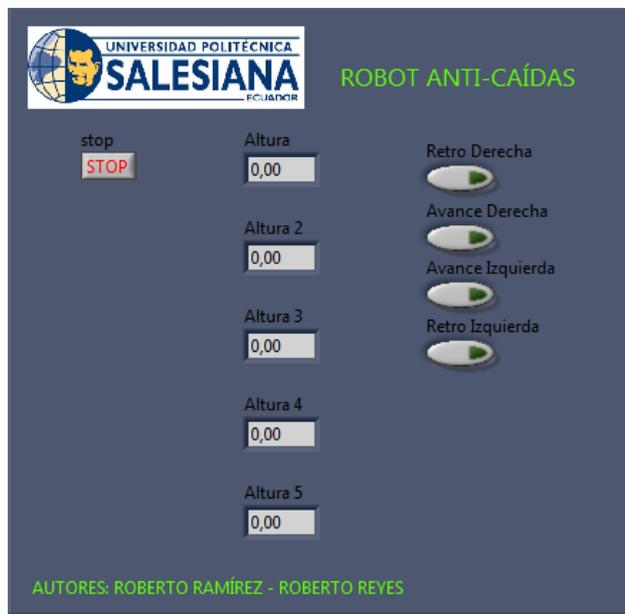
**Figura 4.55** Panel Frontal del VI “Altura”. El panel frontal está diseñado para medir los valores de distancia del robot móvil con respecto al piso donde se encuentra ubicado el robot móvil.
