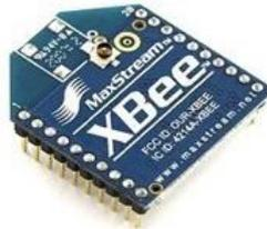
**Figura 4.32** Módulo Xbee Series 1. Imagen superior del módulo Xbee que permite comunicación inalámbrica con un alcance de hasta 90 metros. Gravitech. (2014). XBee 802.15.4 (Series 1) 1mW Point-to-Multipoint RF Module with Chip Antenna. Obtenido de <http://www.gravitech.us/xb80s163porf.html>
