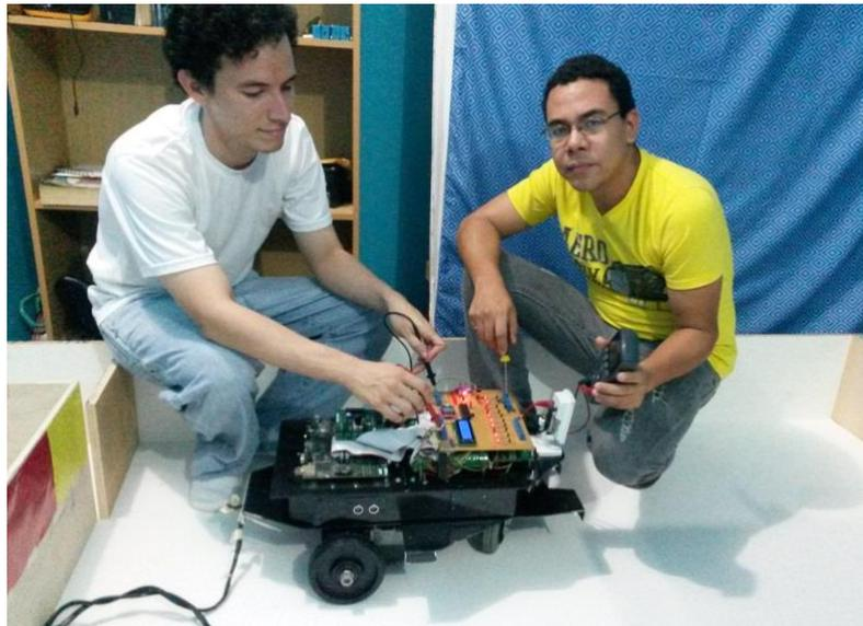
**Figura 3.15** Trabajando con el Robot Móvil. Pruebas de funcionamiento realizadas por los autores para verificar el correcto funcionamiento del Robot Móvil.
