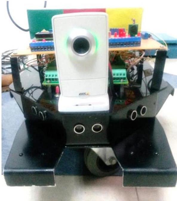
**Figura 4.91** Instalación de cámara de red AXIS y sensores de ultrasonido HC-SR04. Imagen frontal del robot donde se observa las ubicación de la cámara y la posición de los sensores de ultrasonido.
