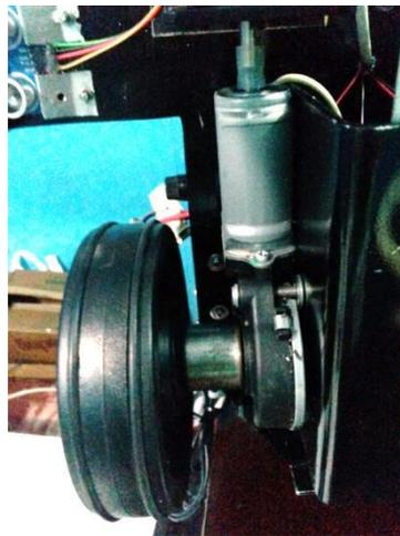
**Figura 3.4** Motores DC junto con las ruedas. Adaptación realizada a los motores DC para que se acople a las ruedas del robot móvil.
