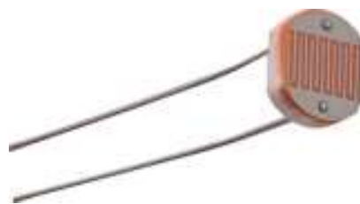
Figura 2.9 Foto resistencia. Modelo físico de una foto resistencia. Por Ingeniatic,( s.f.)
