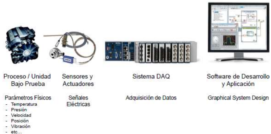
Figura 2.7 Esquema general de adquisición de datos. Ejemplos de equipos / dispositivos que se usan en un sistema de Adquisición de Datos. Por Instruments (s.f)
