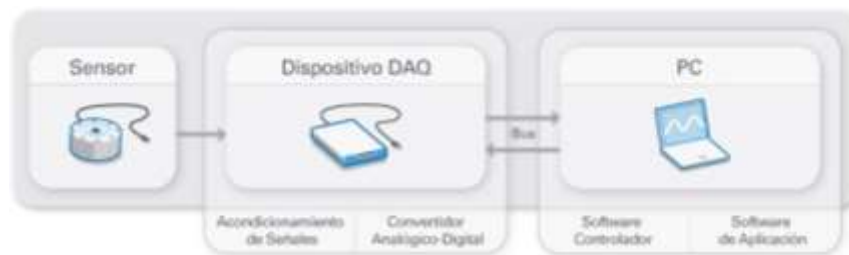
Figura 2.8 Diagrama de conexiones. Se observa en la figura las conexiones básicas de los componentes de un sistema de Adquisición de datos. Por Instruments, (s.f.)
