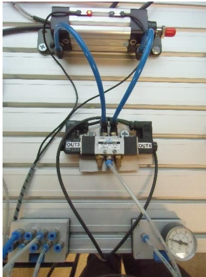
Figura 4-44 Conexiones Neumáticas Físicas
