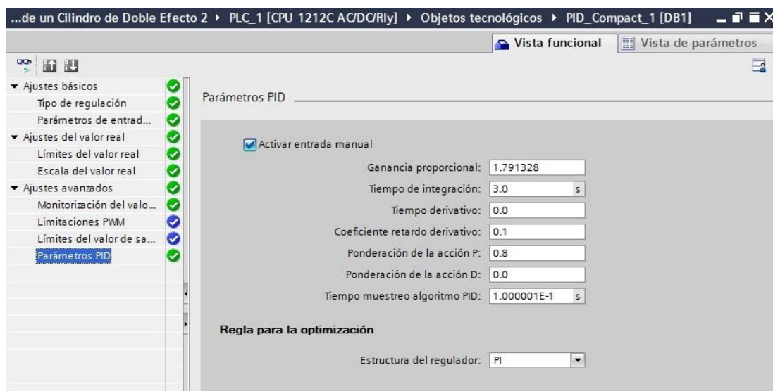
Figura 5-6 Parámetros PI con variación de tiempo de integración a 3
