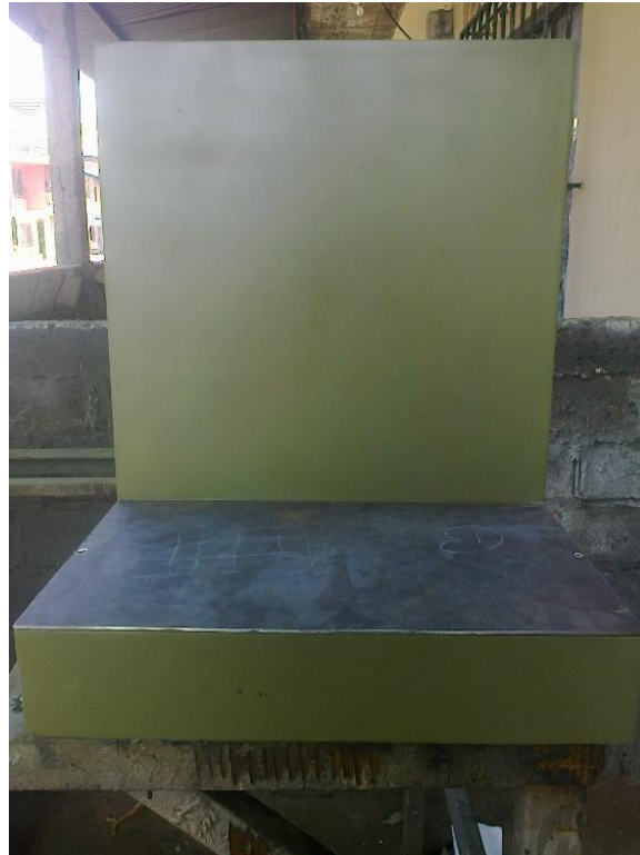
Figura 3-20 Armado de módulo y macillado
