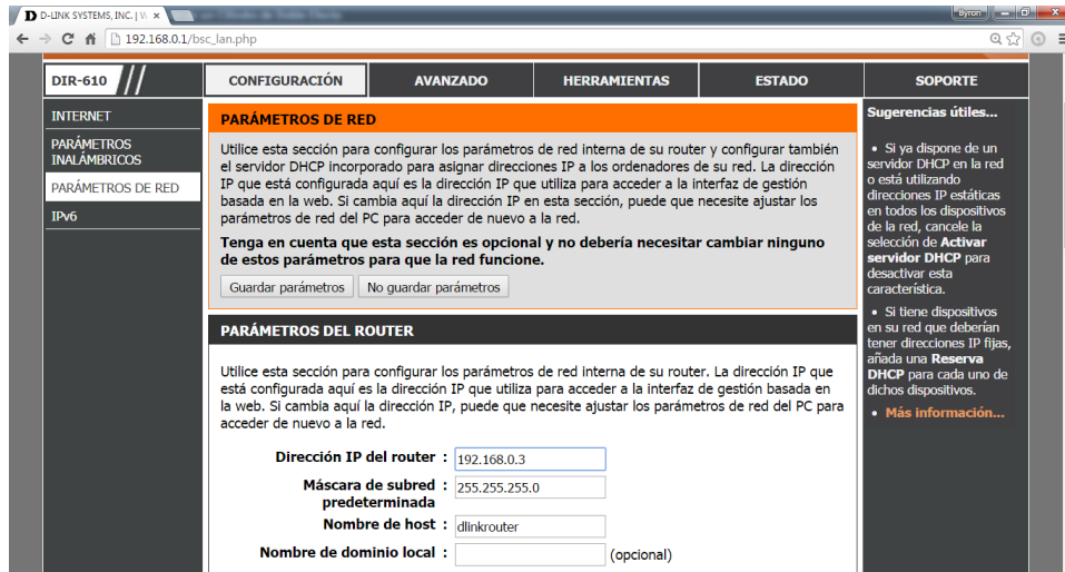
Figura 4-14 Configuración de IP del router
